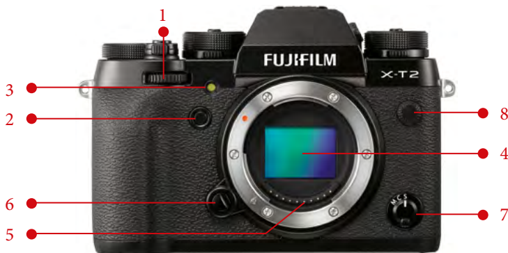
Рис. 1. Камера X-T2, фронтальный вид: передний диск управления с функцией нажатия (1), функциональная кнопка Fn1 (2), подсветка АФ/световой индикатор автоспуска (3), X-Trans сенсор (4), контактная группа объектива (5), кнопка отсоединения объектива (6), переключатель режимов фокусировки (7), синхроконттакт (8)
